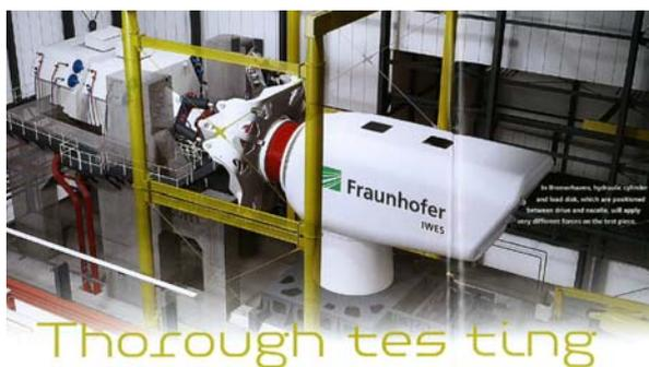
(図表 95) フラウンホーファー研究所 IWES ナセル試験装置
