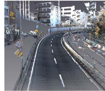
MMSで取得した3次元空間位置データ(レーザー点群)
