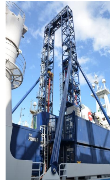
船上設置型ボーリングマシン
