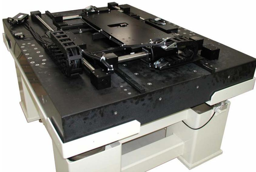
高い技術力をいかし、高精度の精密機器(写真:超高精度薄型X-Yステージ)を製造。大手企業も含めて対等な取引関係を築き、原則として値下げに応じていない。
