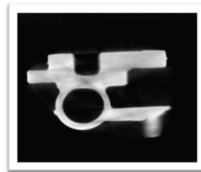
内部形状・欠陥を非破壊にて検査
