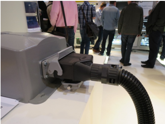
(図表 33) ハノーバーメッセ 2015 スマートファクトリーKLによるデモ工場 モジュールはプラグを差し込めば直ちに接続可能なプラグ・アンド・プレイ方式
