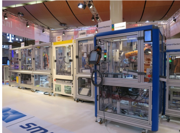
(図表 30) ハノーバーメッセ 2015 スマートファクトリー-KL によるデモ工場 各機械が容易に入れ替え可能な状態になっている
