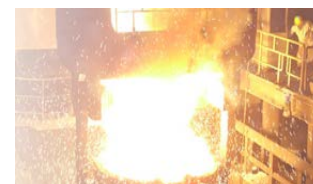
電気炉稼働時の3000℃～7000℃の熱を有効活用し、処理の困難な医療廃棄物等を完全熔融する方法を確立。収集～処理を一貫して行える体制を構築。
