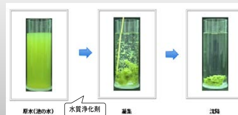
水質浄化剤による凝集の様子(日本ポリグル株式会社WEBサイトより) 水質浄化剤で水をきれいにする子供たち
